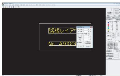
プレートサイズ、文字行数、行間隔などを指定するだけで簡単に、プレート文字彫刻データを作成できる文字枠自動作成機能を搭載。もちろん個別に文字枠を配置して、複雑な文字レイアウトの作成も可能です。
